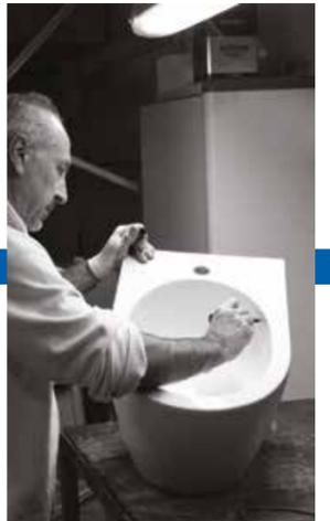
Un nuovo progetto nasce sulla carta nel nostro ufficio tecnico dove l'idea, prima abbozzata, **viene computerizzata in 3D** fino a diventare un prototipo che viene testato e valutato come se fosse un wc in ceramica.
