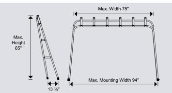
ROCKET LAUNCHER CAN BE TRIMMED TO DESIRED WIDTH AND HEIGHT.
